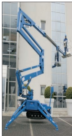
Piattaforma di lavoro mobile elevabile su carro cingolato ("ragno") (B1)
